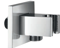
11.685400.2.01 Wand aansluiting square rozet 65 x 65 mm met conus houder voorzien van terugstroom beveiliging chroom
