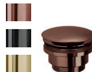
21.432500.1.39 / 40 / 41 Design universele waste valve 1 ¼" met/zonder afsluit functie kan gebruikt worden voor alle wastafels met en zonder overloop Roestvrijstaal PVD* copper steel / black steel / brass steel
