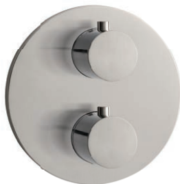
17.500550.1.09 / 17.503050.1.09 / 17.503055.1.09 Inbouw thermostaat round af montage set voor bevestiging op LOGIC PLUS-Box voor 1, 2 of 3 gebruikers Veiligheidsbegrenzer op 38° C tegen te hoge temperaturen met metalen rozet ten behoeve van de koppelingen Ø 150 mm Veiligheidsbegrenzer op 38° C tegen te hoge temperaturen Roestvrijstaal * 17.500550.2.09 / 17.503050.2.09 / 17.503055.2.09 180 x 130 mm
